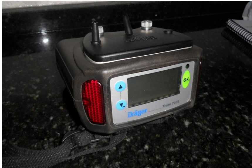
Figura 9. Dräger x-am 7000, utilizado para análise da composição do biogás.
