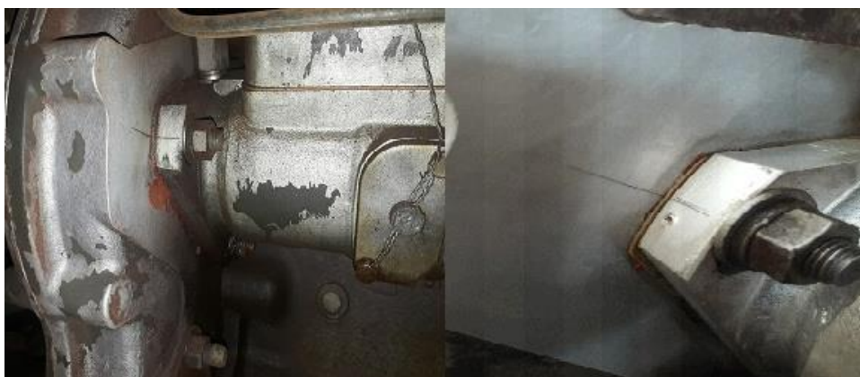
Figura 7 – Referência genuína do ponto inicial de injeção da bomba injetora. Fonte: Elaborado pelo autor.
