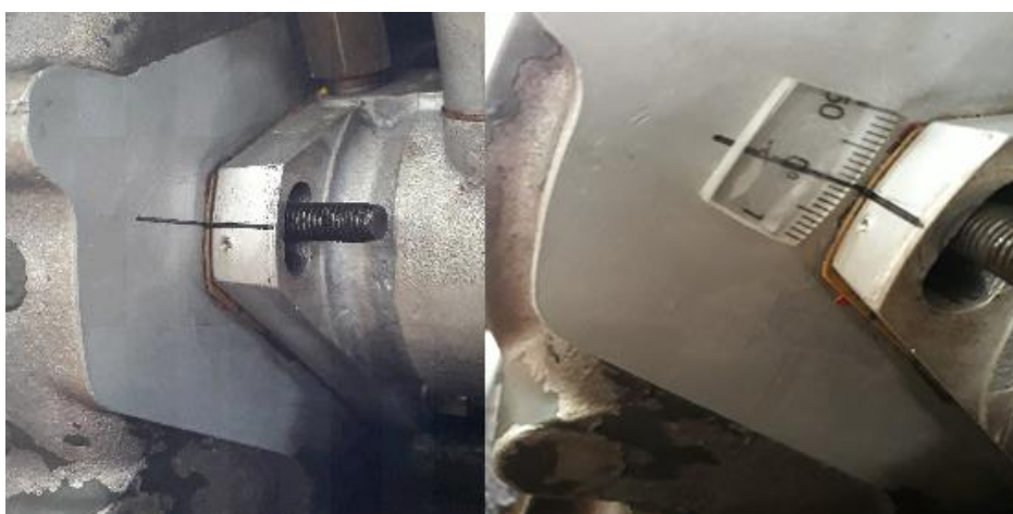
Figura 8 – Referência genuína do ponto inicial de injeção, com adequação para o ajuste mecânico da bomba injetora. Fonte: Elaborado pelo autor.
