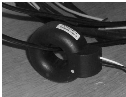
FIGURA 6 – Transformador de corrente CS10-L Campbell Scientific.
