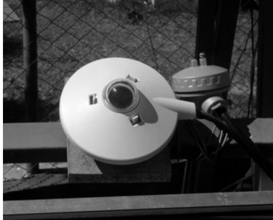
FIGURA 5 – Piranômetro CMP3 Kipp & Zonen.
