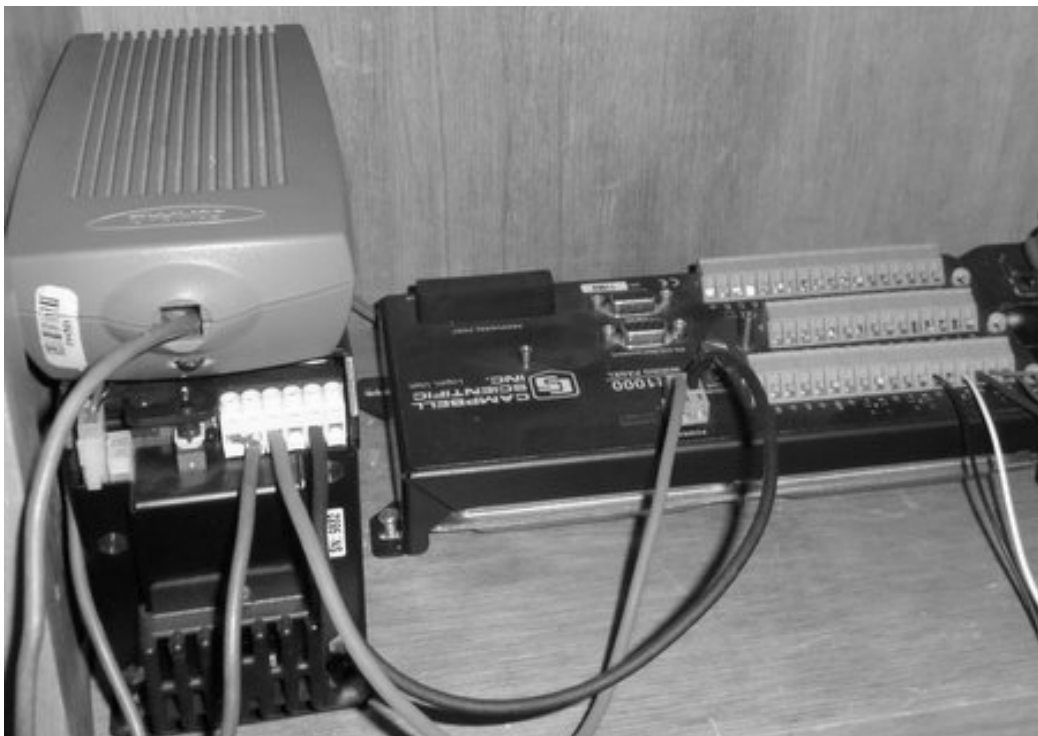
FIGURA 7 – Datalogger CR1000 Campbell Scientific, carregador e bateria.
