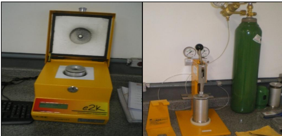
Figura 13. Bomba Calorimétrica utilizada.
