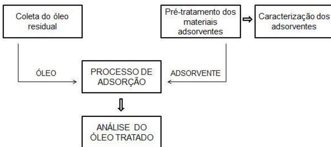
Figura 3 – Fluxograma das etapas de tratamento do óleo residual a partir de adsorção.
