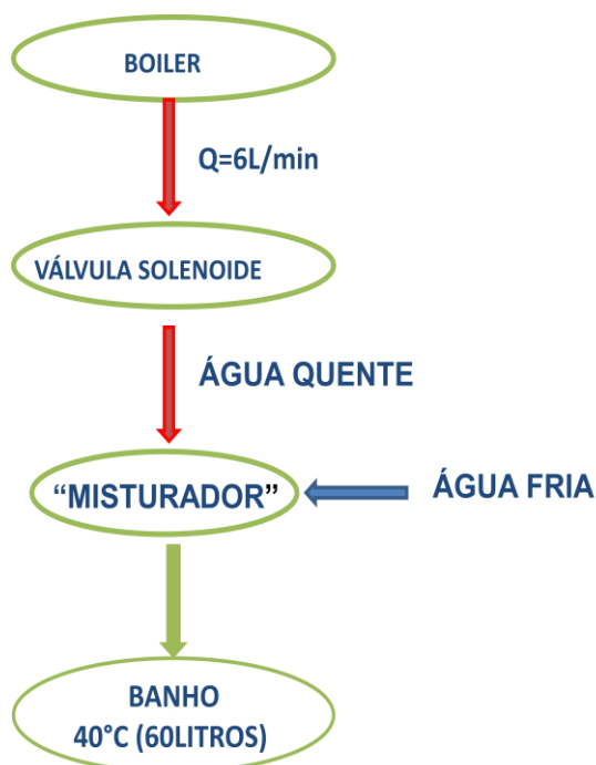
Figura 26: Diagrama do misturador de água quente/fria proposto.
