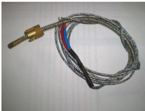
Figura 17: Termopar tipo J utilizado para as medições de temperatura.
