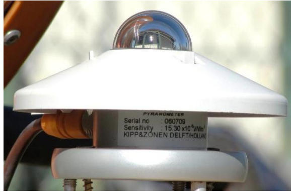
Figura 21: Piranômetro usado para medição da radiação solar.
