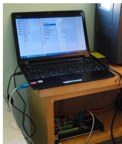
Figura 16: Datalogger CR 1000; conexões ao computador.
