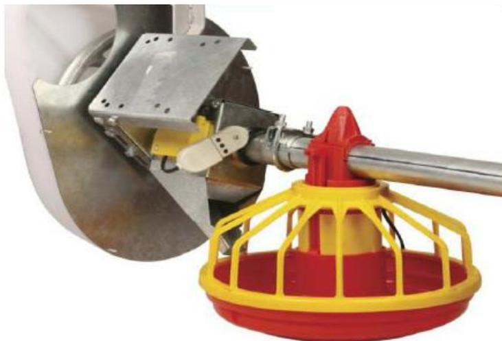
**Figura 10:** Conjunto acionamento e comedouro automático
