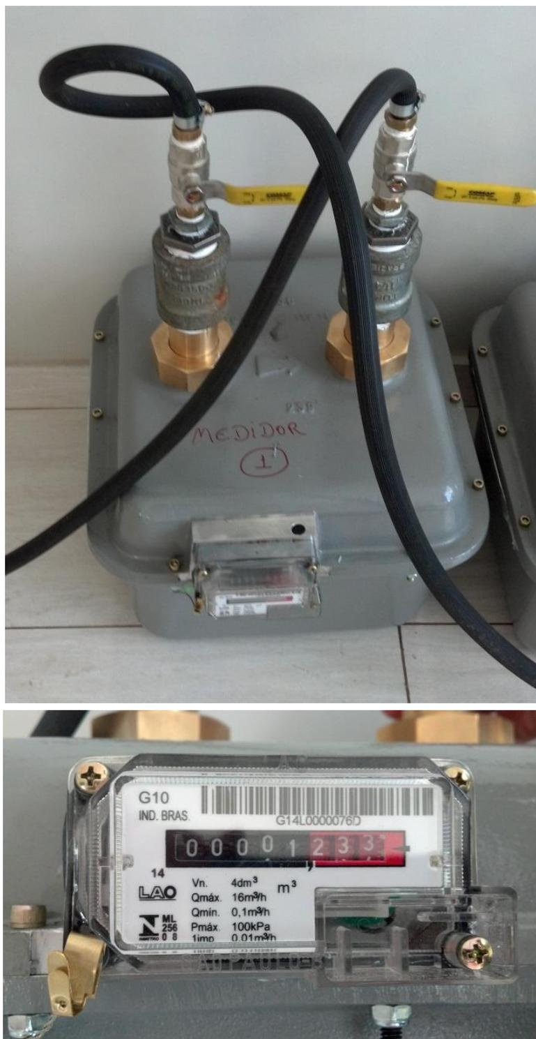
**Figura 36:** Detalhe equipamento e painel de registro do medidor volumétrico de gás G10, marca LAO
