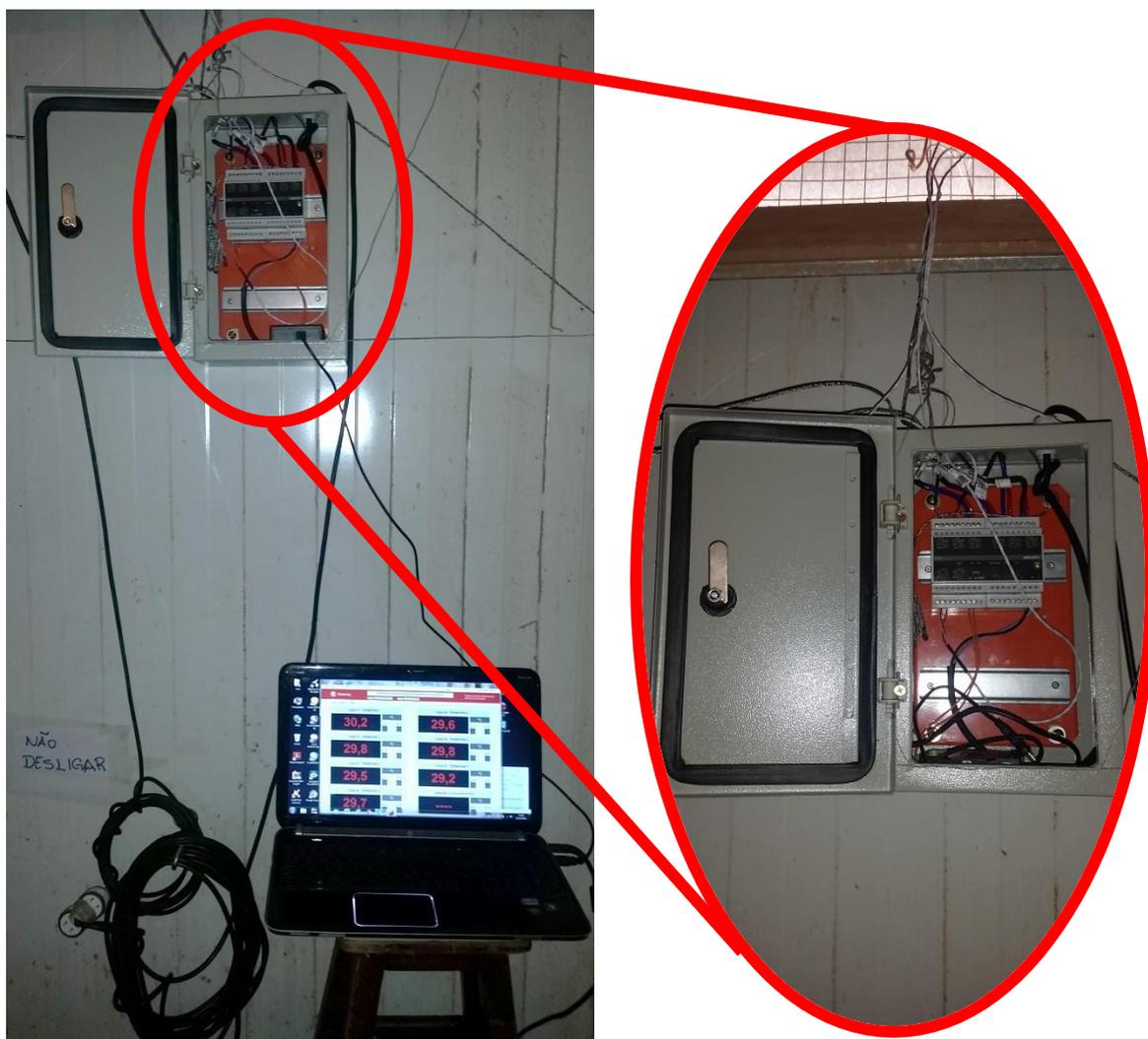
**Figura 34:** Datalogger MasterLogger A 202 instalado no aviário DHIT
