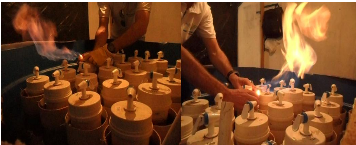
Figura 12. Comprovação da produção de \text{CH}_4 em diferentes tratamentos. Fonte: Elaborado pelo autor, 2013.
