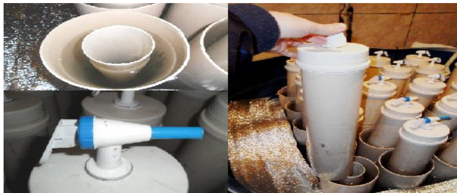
Figura 07. Detalhe da câmara digestora, válvula de coleta e gasômetros. Fonte: Elaborado pelo autor, 2013.
