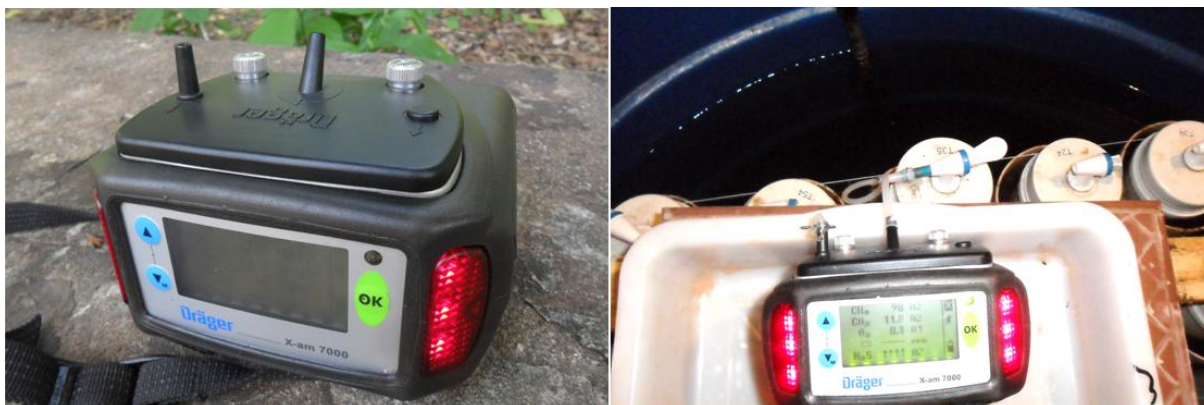
Figura 09. Aparelho Dräger X-am 7000 (1) conectado aos gasômetros (2). Fonte: Elaborado pelo Autor, 2013.
