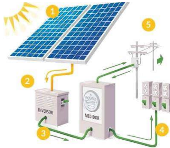
Figura 15: Sistema fotovoltaico Grid_tie. Fonte: MaxiSolar, 2016.
