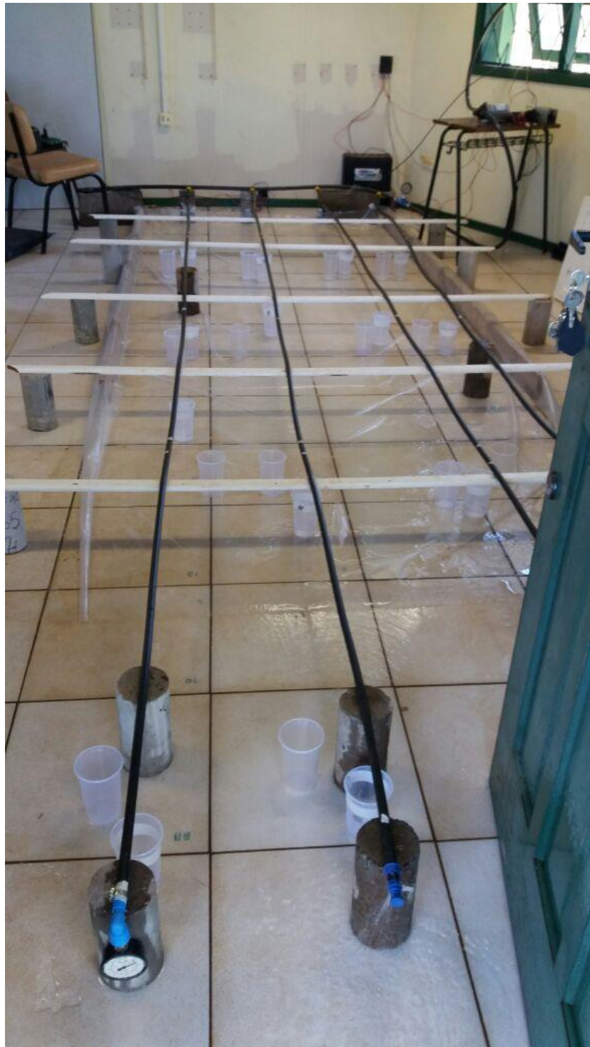
Figura 8: Tubos Gotejadores. Fonte: (Autor, 2016).
