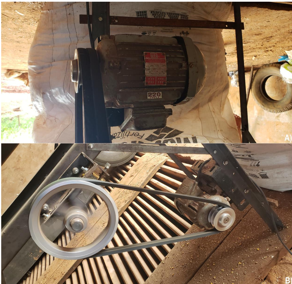
Figura 6. Motor (A), forma que o motor foi acoplado na estrutura da correia transportadora (B).
