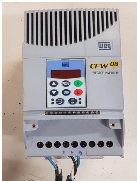
Figura 7. Inversor de frequência, WEG.
