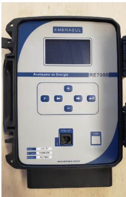
Figura 8. Analisador de energia EMBRASUL - RE7080.
