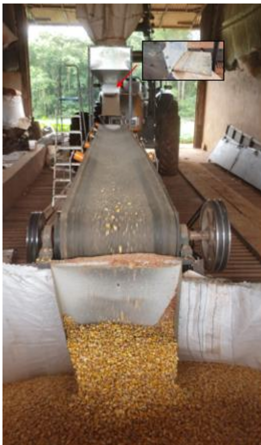
Figura 5. Correia transportadora construída.
