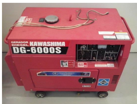
Figura 5: Conjunto motor gerador utilizado nos ensaios. Fonte: do autor.
