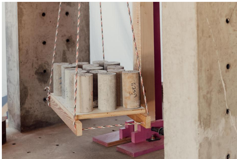
Figura 17 – Bandejas para aplicação de carga nos beirais.
