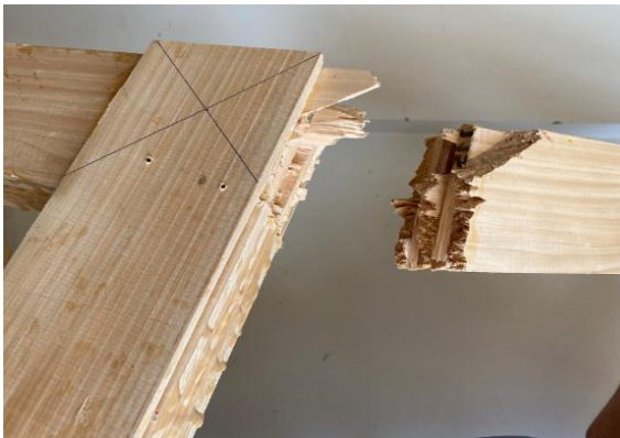
Figura 20 – Detalhes de ruptura do pórtico 3, vistas frontais dos nós C e D, respectivamente.
