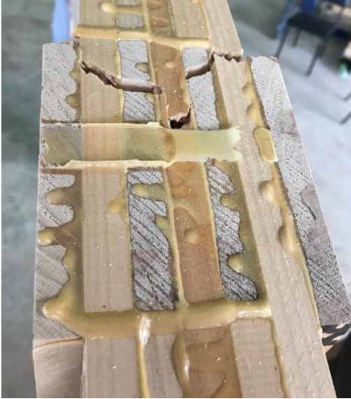
Figura 19 – Detalhes de ruptura do pórtico 2, vista superior do nó C e frontal do nó D, respectivamente.
