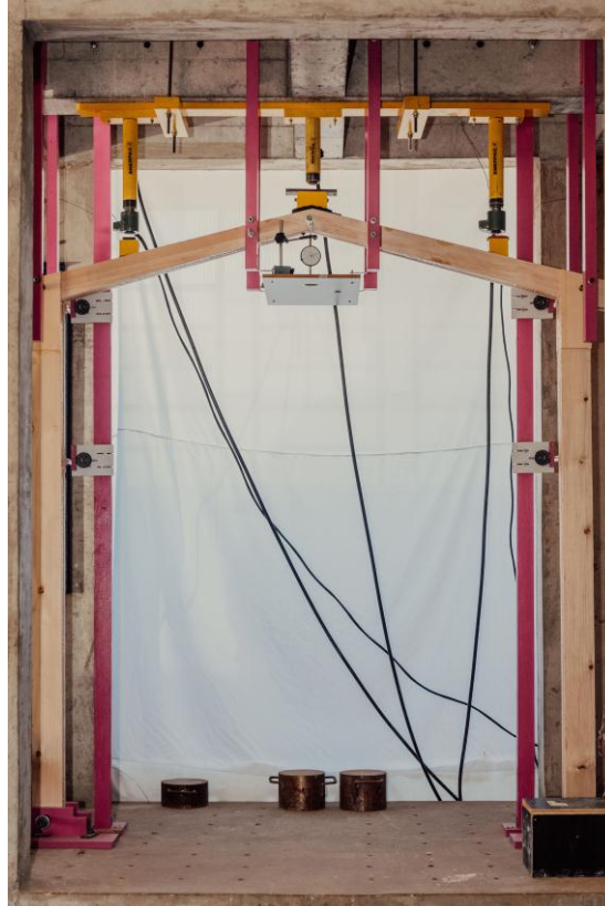
Figura 16 – Pórtico e aparatos instalados para o teste.
