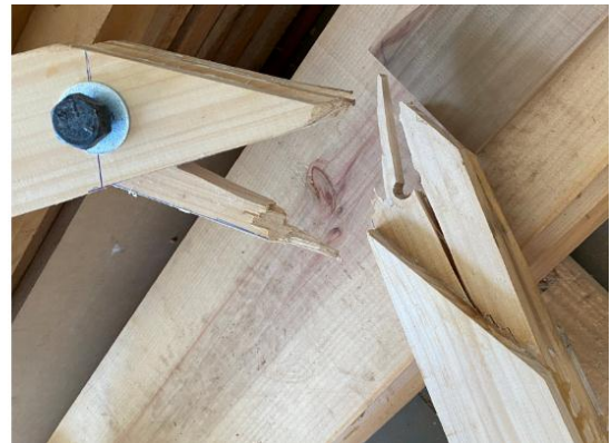
Figura 20 – Detalhes de ruptura do pórtico 3, vistas frontais dos nós C e D, respectivamente.
