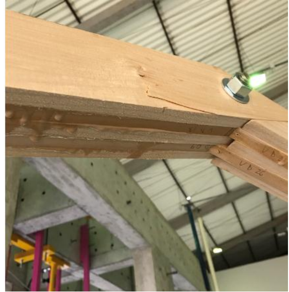
Figura 19 – Detalhes de ruptura do pórtico 2, vista superior do nó C e frontal do nó D, respectivamente.
