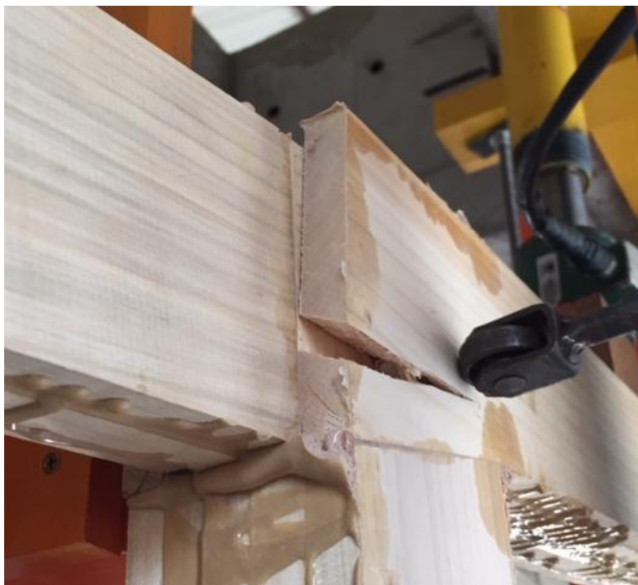
Figura 11 – Ruptura por tração perpendicular às fibras em estrutura sem reforço.
