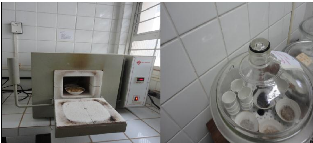
Figura 06: Biomassa na Mufla para Análise e Posteriormente colocada em um Dessecador.
