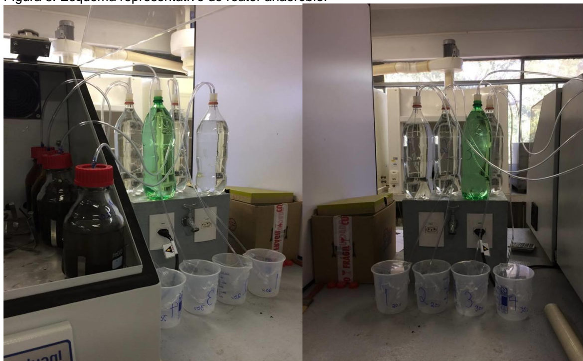
Figura 5: Esquema representativo do reator anaeróbico.
