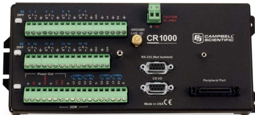
Figura 27 - Datalogger CR1000 da Campbell Scientific. Fonte: Campbell Scientific (2020).
