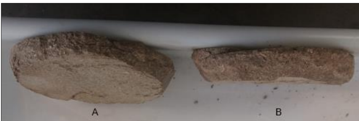
Figura 13 – Discos de amostras dos briquetes. (A) Disco de 1 cm, (B) Disco de 2 cm.
