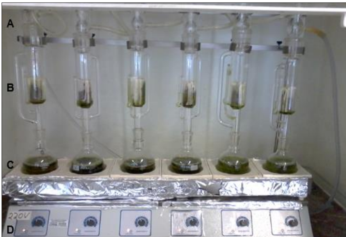
Figura 16 – Esquema de extração das amostras.
