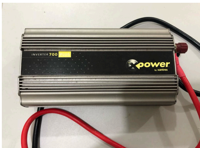
Figura 18. Inversor Xantrex XPower 700 plus. Fonte: NEOSOLAR (2020).
