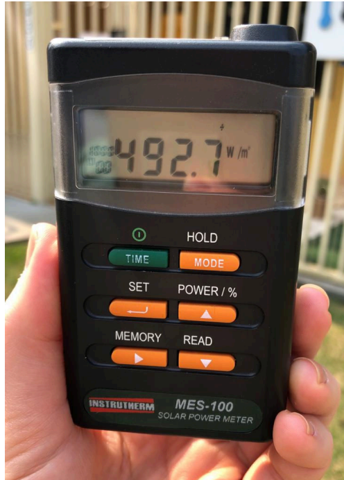
Figura 16. Medidor de radiação solar Mes-100. Fonte: INSTRUTHERM (2020).
