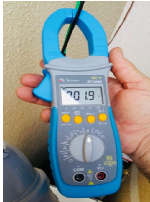
Figura 17. Amperímetro alicate ET- 3880. Fonte: MINIPA (2020).
