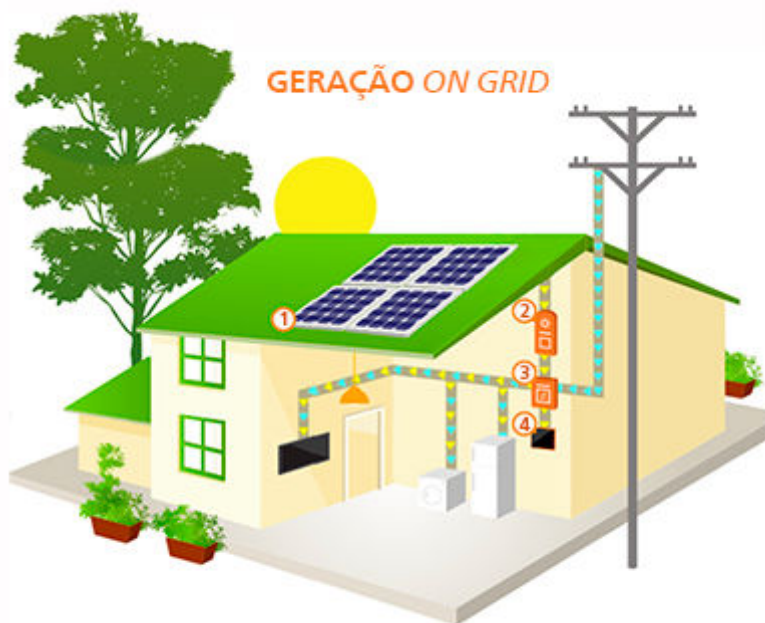
Figura 5. Sistema fotovoltaico conectado à rede (SFVCR) ou On Grid . Fonte: CLEAN ENERGY (2020).
